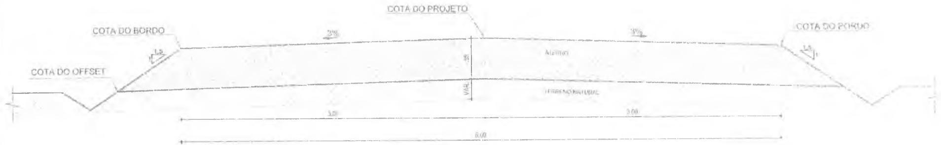
01 | SEÇÃO TIPO DE PAVIMENTAÇÃO - ATERRO / CORTE - A
